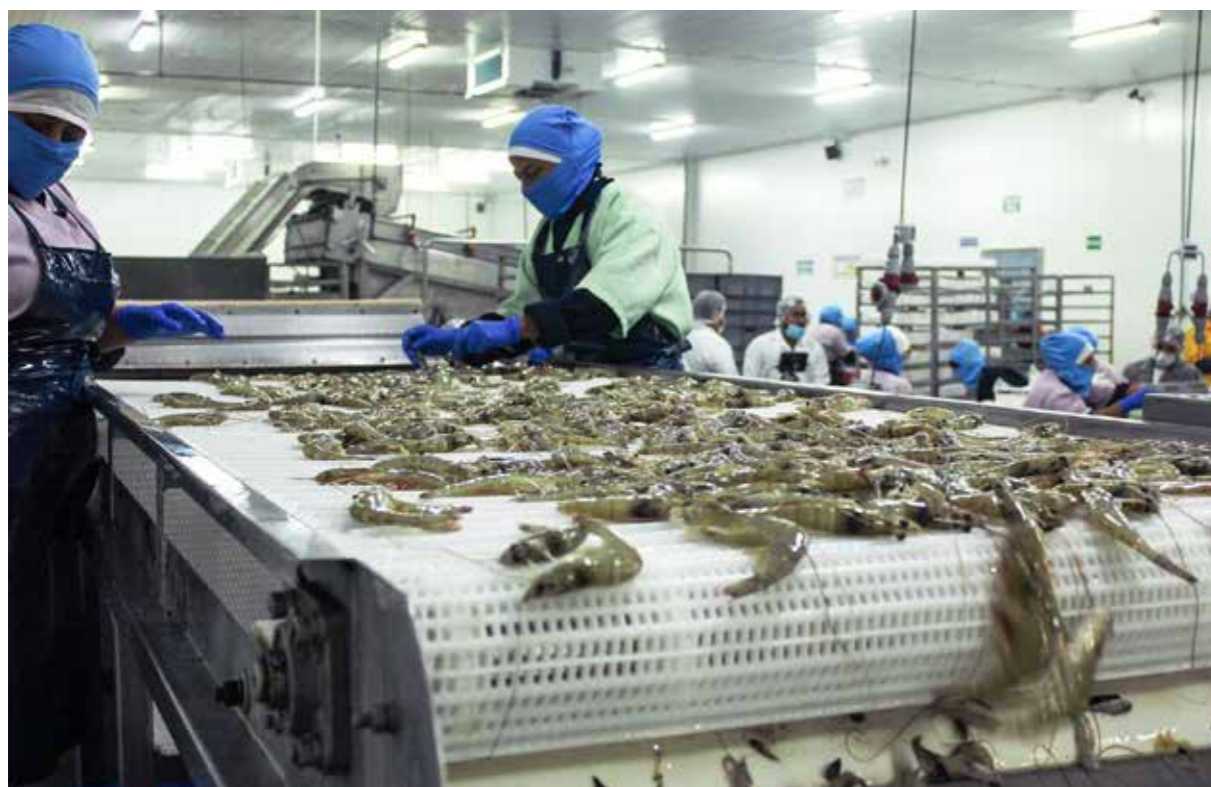
La máquina clasificadora de camarón de Balzo permite trabajar con 5 tamaños del marisco, en líneas de 2.000 a 6.000 libras por hora.
